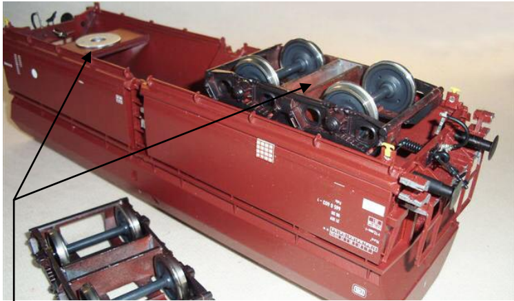
● M: draaistel met grote schroef / Drehgestelle mit große Schraube
